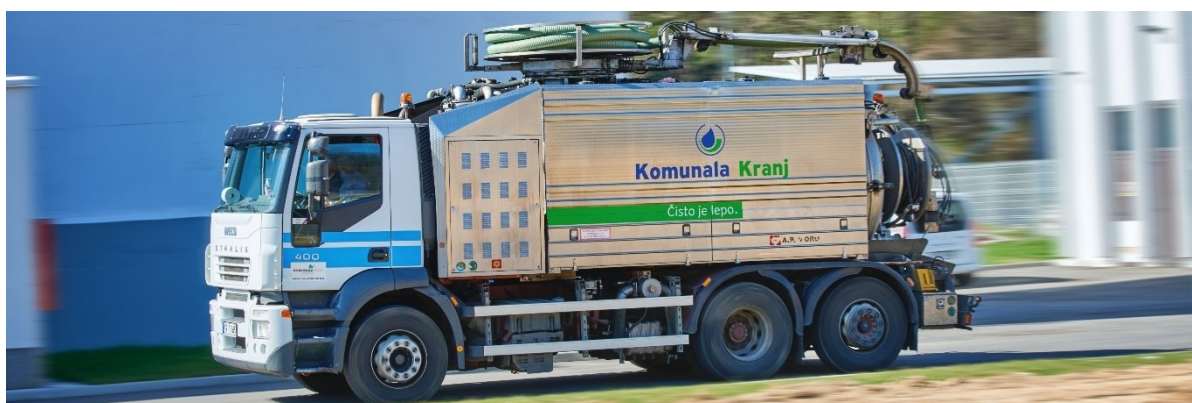
Slika 7: Vozilo za prevoz blata in čiščenje kanalizacije
